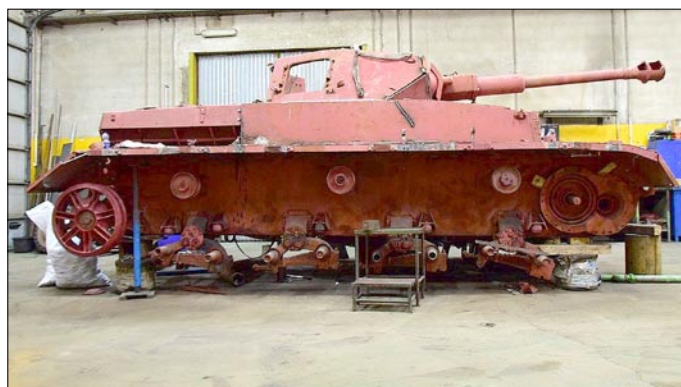
W czerwcu 2016 r. zakończono kompletowanie bryły czołgu z Kluczewa. Wszystkie oryginalne elementy zostały w profesjonalny sposób zakonserwowane (Foto: Aleksander Ostasz).
