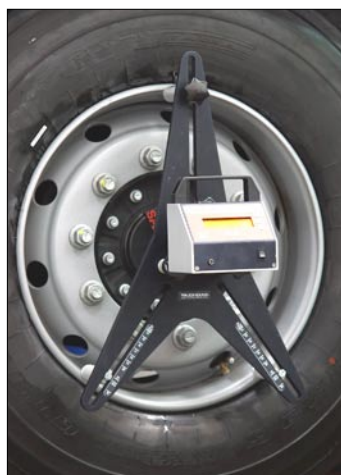
Fot. 3. Mocowanie zacisku na krawędzi obręczy. (fot. TRUCK LINE – PRECYZJA SERVICE)
