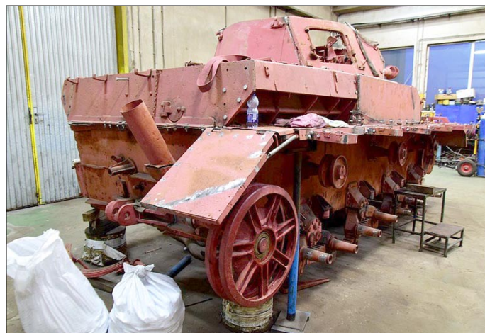
Prawy, tylny narożnik czołgu z Kluczewa podczas odbudowy w czerwcu 2016 r. Dobrze widoczne koło napinające oraz wózki podwozia jeszcze nieposiadające kół jezdnych (Foto: Aleksander Ostasz).
