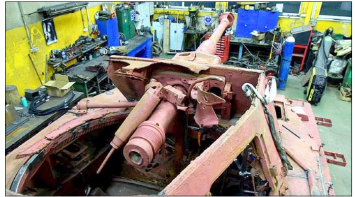
Dużym problemem w procesie odbudowy czołgu było odtworzenie mocno zniszczonej wieży (Foto: Aleksander Ostasz).
