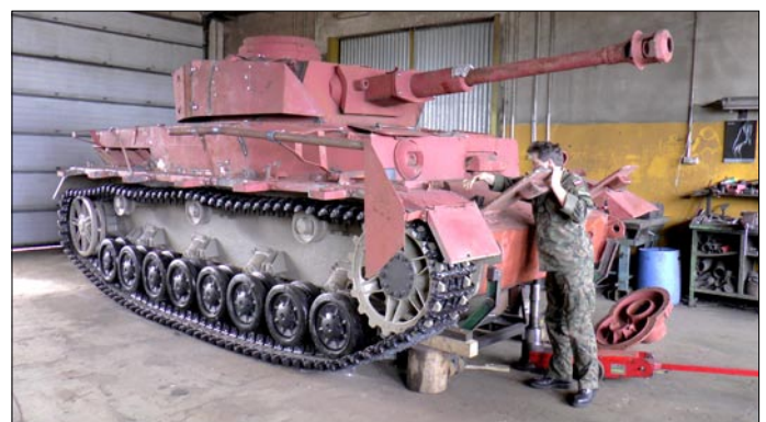
Od początku odbudowy zadbano o to, żeby nowy w kolekcji Muzeum Oręża Polskiego w Kołobrzegu czołg posiadał jak najwięcej oryginalnych części. Na zdjęciu: kompletowanie układu przeniesienia napędu w czerwcu 2016 r. (Foto: Aleksander Ostasz).
