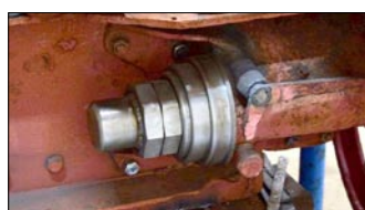
Elementy, które nie zachowały się w oryginale, zreplikowano z zachowaniem właściwych materiałów, wymiarów i kształtu. Na zdjęciu: część systemu prawego napinacza gąsienicy (Foto: Aleksander Ostasz).
