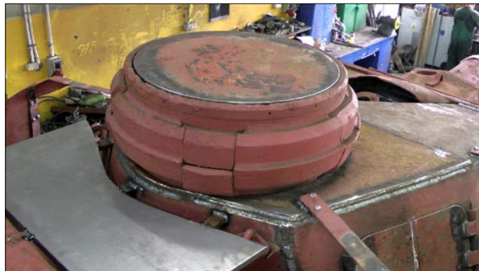
Dach wieży czołgu Pz.Kpfw. IV Ausf. J z Kluczewa, z zainstalowaną basztą dowódcy. Tuż za tylną krawędzią widoczny jest dorobiony współcześnie, górny element zasobnika na wyposażenie dodatkowe, tzw. „skrzynki Rommla” (Foto: Aleksander Ostasz).
