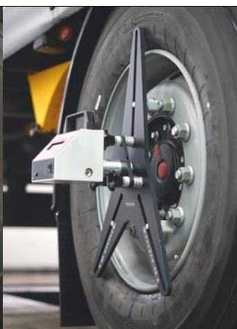
Fot. 4. Mocowanie za pomocą uchwytów magnetycznych-bez kompensacji bicia. (fot. TRUCK LINE – PRECYZJA SERVICE)
