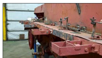
Charakterystyczne dla czołgów Pz.Kpfw. IV Ausf. J mocowania siatkowych ekranów pancernych typu Thoma Schuerzen. Szczęśliwie, te unikatowe elementy zachowały się niemal w całości w oryginale (Foto: A. Ostasz).
