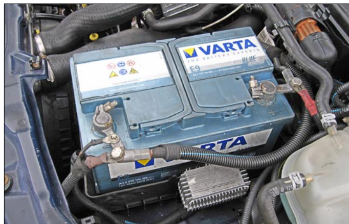
Podstawowym warunkiem zapewnienia bezpieczeństwa przy pracach blacharsko-spawalniczych jest demontaż akumulatora z pojazdu.
