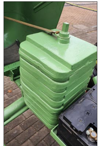
Ciekawostka konstrukcyjna modelu F12 – regulowana przeciwwaga, zainstalowana obok akumulatora.
