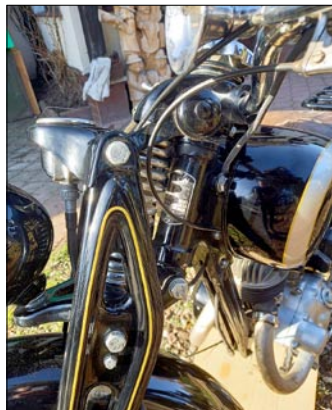
Oryginalność pojazdu sięga do słownie śrubki. Elementy motocykla łączone są charakterystycznymi dla lat trzydziestych śrubami Ribe (Fot. Przemysław Groński).
