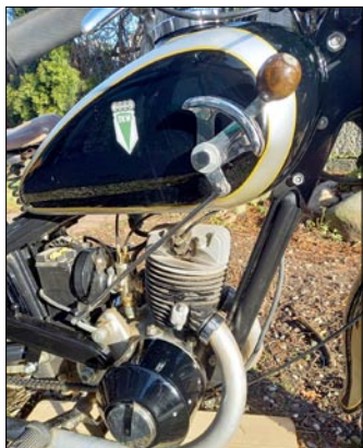
Dwusuwowy silnik o mocy 7 KM i pojemności 200 ccm był jednym z bardziej ekonomicznych, jakie wyprodukowała fabryka DKW w Zschopau (Fot. P. Groński).
