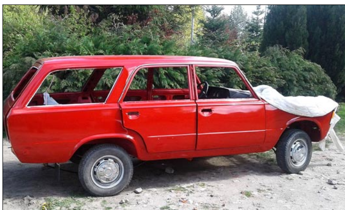
Karoseria po zakończeniu malowania. Kolor dobrany został na podstawie tabliczki znamionowej oraz zachowanych fragmentów oryginału (Foto: Arkadiusz Trzcński).
