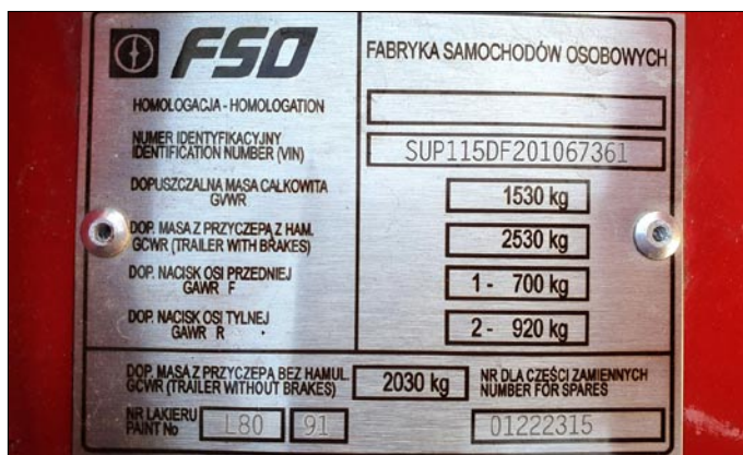
Oryginalna tabliczka znamionowa prezentowanego samochodu. Odczytać z niej można m.in. numer koloru nadwozia (Foto: Łukasz Gładysiak).
