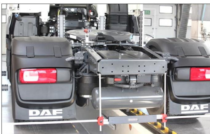
Fot. Pomiar geometrii układu jezdnego w odniesieniu do ramy pojazdu. (TRUCK EXAM) Fot. Herkules
