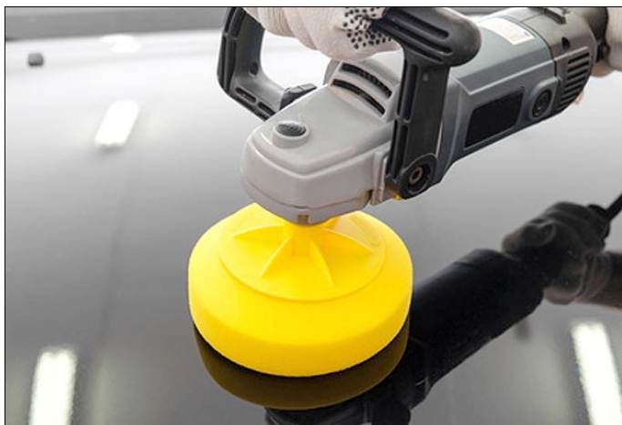
Fot. Polerowanie to rodzaj obróbki ściernej. (Fotolia)
