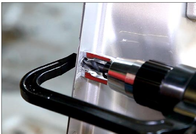
Fot. Frezowanie (rozwiercanie) zgrzeiny to rodzaj obróbki skrawaniem. (HERKULES)
