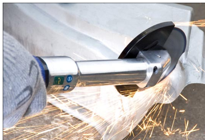
Fot. Cięcie przy pomocy szlifierki kątowej też jest rodzajem obróbki ściernej. (EZ-DENT)
