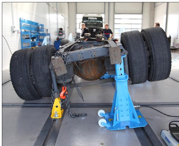
Fot. Wypychanie pionowe – usuwania skręcenia ramy. (HERKULES TRUCK HYBRID) Fot. Herkules
