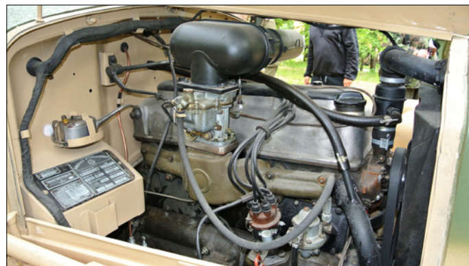
Atutem Mercedesa Benza L1500S z Dąbrowki jest pieczołowicie odrestaurowany i w pełni sprawny, oryginalny silnik typu 32 FF JPI o pojemności blisko 2600 ccm i mocy 60 KM (Foto: Łukasz Gładysiak).
