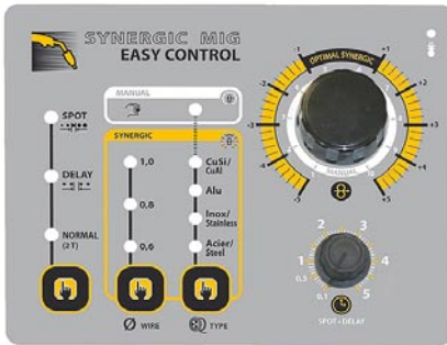
Fot. 4 Na panelu sterującym lutospawarki wybiera się rodzaj i średnicę drutu. Po wybraniu żądanego prądu pracy prędkość posuwu drutu dobierana jest automatycznie. DUOGYS AUTO. (GYS)
