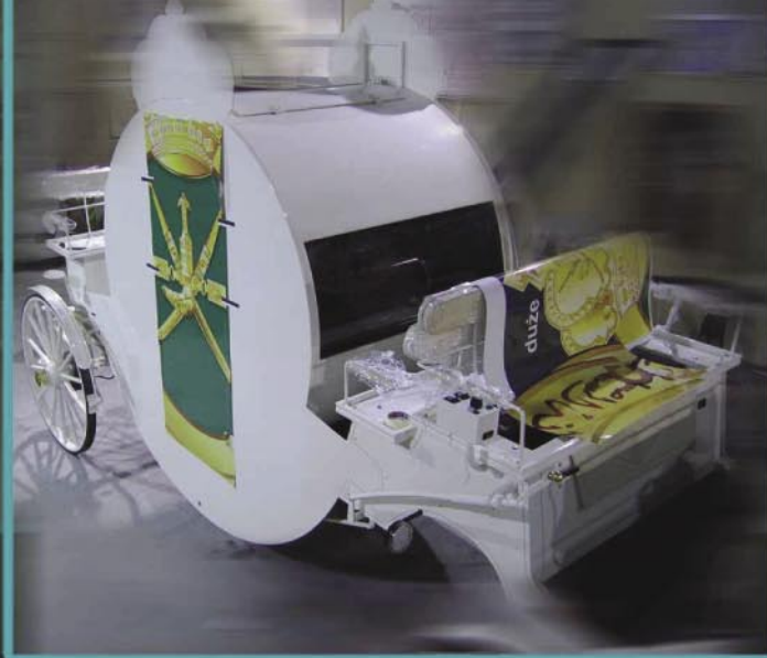
Tył powozu; oświetlenie, stopnie, skórzane wykończenia.
