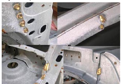
Fot. 2 Przykładowe połączenia lutowne w karoserii samochodowej. (GYS)
