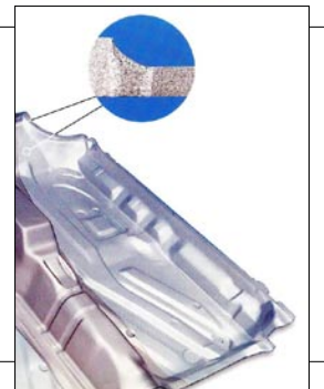
Fot.2. Drzwi samochodu wykonane w technologii TB. Widoczne elementy o zróżnicowanej grubości. (ThyssenKrupp)
